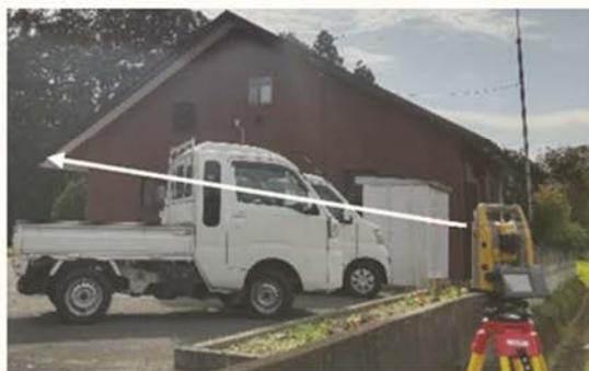
図 4-4 水平精度の検証（建物の測量）
